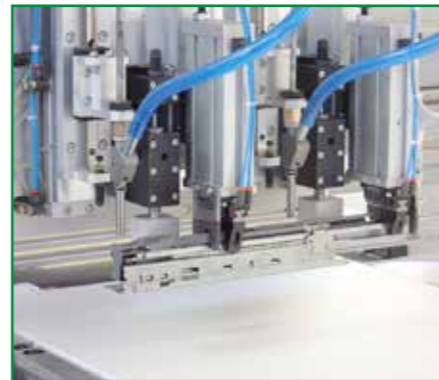
Gruppo inserimento guida Inserting group for drawer runners
