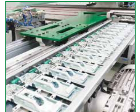
Inserimento reggipensili a scomparsa Insertion of retractable hanging brackets
